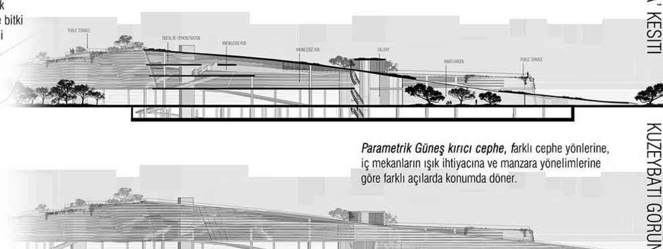
Parametrik Güneş kırıcı cephe, farklı cephe yönlerine, iç mekanların ışık ihtiyacına ve manzara yönelimlerine göre farklı açılarda konumda döner.
